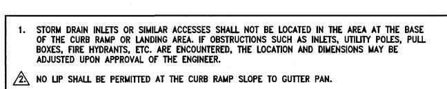
PLANTMIX BITUMINOUS SURFACE SHALL BE FLUSH WITH THE EDGE OF THE GUTTER PAN IN THE AREA OF THE CURB RAMP.
